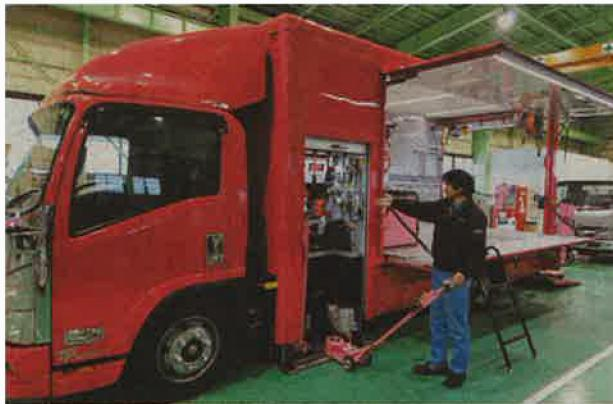
第3世代の特徴は荷台兼作業室の新レイアウト。大きな電機ケースを、運転席側に縦置きで据えた。従来機の横置き方式は、作業室を広く使えるが、発電機のメンテナンス作業には窮屈だった。縦置きで、ボディー側面の扉からコンプレッサーと一緒にわせ、作業が楽にできるようにした。
