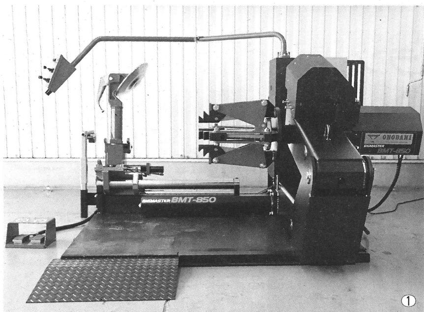
小野谷機工は、大型車用タイヤチェンジャー「ビッグマスター」を一新し本格発売する。シリーズの初代モデルを13年ぶりに大幅リニューアル。「BMT-850(適応リム径16~30インチ、最大タイヤ幅850ミリ)・1250・1250X(ともに適応リム径16~35インチ、最大タイヤ幅1250ミリ)」シリーズとしてラインアップした。
