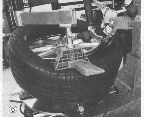
(写真上から)①本機と竹内さん、デュアルツールの②Bプロローと③DTヘッド、④新形状チャック爪とホイール受けプロテクターを配置したターンテーブル、⑤ダイヤルゲージタイプのエアメーター、⑥タイヤ組み付け作業)
