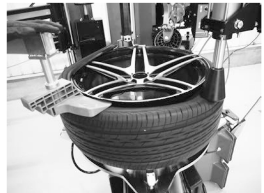
(写真上から)「新型ホイールプレス装置」で楽に、確実にチャッキング。「サードプレス装置」がレバーレス作業をより容易に行うことを可能に。
