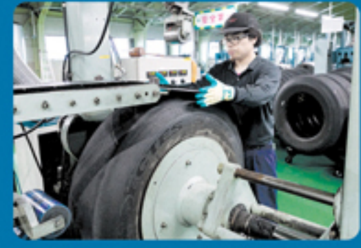
新しいトレッドパターンを形成するゴムを巻きつけます。重量、長さなどチェック項目が多く、難しい作業です。
