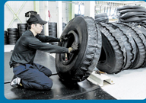
台タイヤとトレッドゴムを接着させる際に、重要な工程です。品質に影響する為、最も気をつける作業になります。
