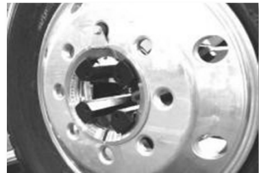
③ チャック爪の方向・位置を確認しチャッキングします
