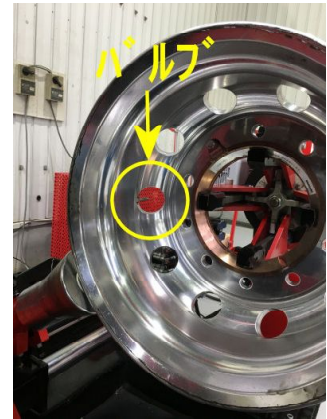
fig.1 『自動/手動』スイッチ fig.2 『タイヤ回転』スイッチ fig.3 バルブ移動位置 fig.3 のバルブ移動位置は 60Hz 仕様を 60Hz 環境化で動作させた時の位置となります。50Hz 地域ではバルブ移動位置が異なる場合があります。
