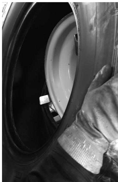
②タイヤ爪を反転して前方へ移動します。再度、マウントクランプをセットしてタイヤ爪をホイールとビード間に差し込み、ビードをタイヤ爪先端で受けます。ホイールを右回転して表側ビードを組み込みます。ビード組込みが完了したら、マウントクランプを取り外します。タイヤ爪をビードから引き抜く際は、ホイールを左回転しながら引き抜いてください。
