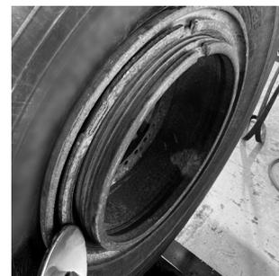
⑥ロックリングの先端部を溝に合わせ、ホイールに取り付けます。ツールをセットして皿形ツールでロックリングを押し込みながらタイヤを回転させて組み込みます。
