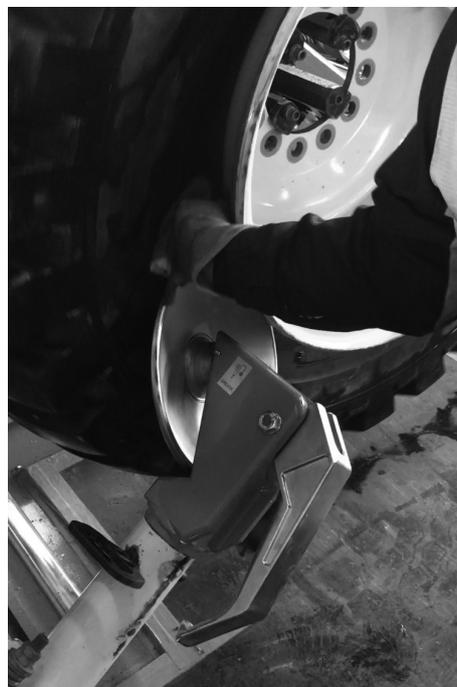
③タイヤ爪をセットします。タイヤを前進させホイールとタイヤ間にタイヤ爪を差し込み、タイヤ爪先端部にビードを引っ掛けます。タイヤレバーをタイヤ爪右側にセットし、タイヤを左回転して表側ビードを引き出します。
