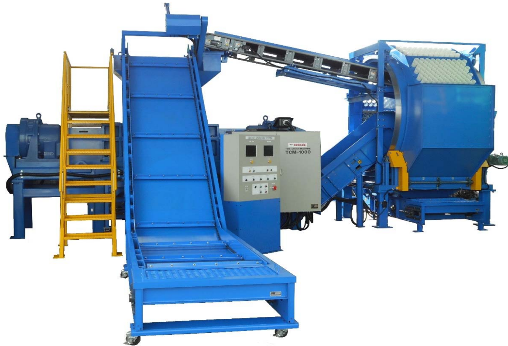
※写真はタイヤ破碎システム「TCM-1000シリーズ」の一例です。
