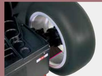
レーザーセンサーによる自動入力
