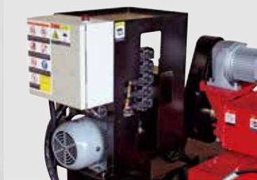
スイッチ操作により油圧ポンプが起動する省電力ユニットは、使用電力をセーブしつつ騒音の発生を減らし、さらには作動油の温度上昇や劣化抑制にも効果を発揮します
