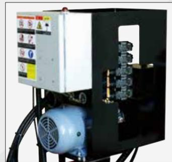
リモコンスイッチの操作で油圧ポンプが起動する
