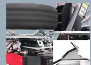
従来より約13mm高い位置で固定しクリアランス確保やビードアップローラー差し込みが容易に行えます
