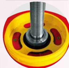
センターリングガイドによりアタッチメントが中心からズレずに作業ができます。
