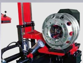
ホイールだけのチャッキング時も、タイヤリフトの上昇で安全にチャッキング作業が行えます
