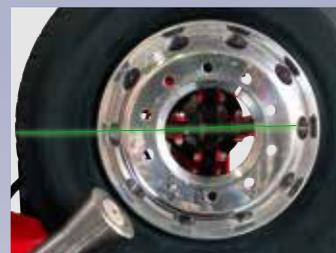
ラインレーザーボタンを押せばチャック中心高さにレーザーが照射するので、チャッキング時リフトの高さあわせがスピーディーに行えます
