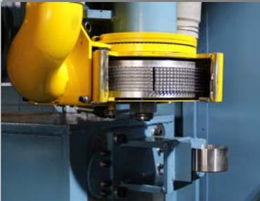
ラaspとピーリングのダブルアクションにより、スピーディーにタイヤ切削を行えます。
