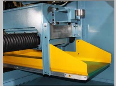
ピーリング切削で発生したゴムを機外に排出。狭い場所での作業を軽減します。
