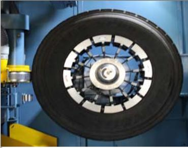
エキスパンドドラム方式により、簡単にタイヤをセットできます。
