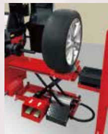
バランスーに取付のため ターンテーブルでタイヤ ホイールの方向転換
