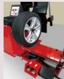
リフトの昇降ならびにス ライドでバランスーに セット
