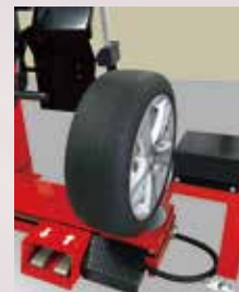
終了後にリフトを下降し タイヤの取り出し
