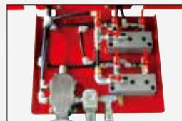
車両をリフトアップした状態で万が一空気バネが破損した場合に簡易的なバルブ操作で車両の緊急下降を行えます
