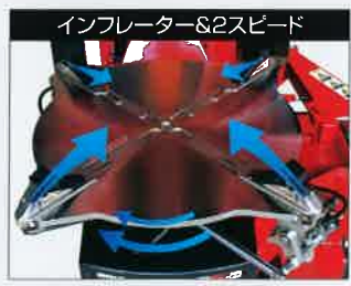
インフレーター&2スピード チャック爪後部からエアジェット噴射 また回転ペダルを軽く踏み低速回転、 深く踏み高速回転の2スピード仕様
